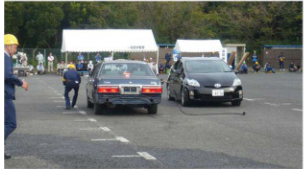
セフティカップリングが作動、その作動音に驚き ホースを付けたまま急発進。対向車と接触事故
